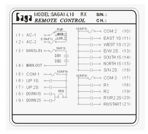
**SAGA1-L10 Wiring Diagram**
