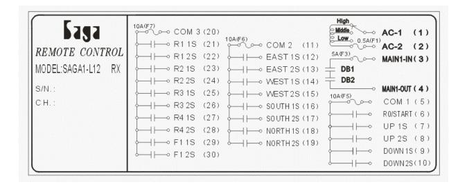
**SAGA1-L12 Wiring Diagram**
